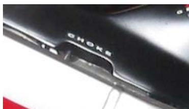
Oltre ai sintomi sopra citati, saliamo sulla moto. Va male? Proviamo a tirare lo starter (o l'aria, come voi erroneamente la chiamate). Lo starter ingrassa la carburazione su tutto l'arco di aperture: serve quando il gt è freddo, e la benzina al posto di stare in sospensione in camera di scoppio, si deposita sulle pareti fredde del cilindro, condensando, e non partecipando alla combustione, rendendo necessario un aumento della percentuale di benzina, per far scoppiare il motore.
