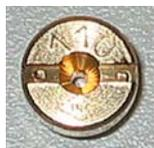
Parliamo appunto di quelli del massimo e del minimo, ovvero che regolano la carburazione alle diverse aperture della manopola del gas, o meglio dire, della ghigliottina, che ora andremo ad analizzare.
